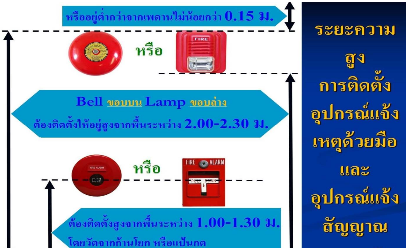
รูปแสดง แนวทางตำแหน่งระยะความสูงการติดตั้งอุปกรณ์แจ้งเหตุด้วยมือและอุปกรณ์แจ้งเหตุสัญญาณ
